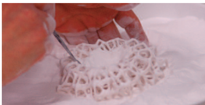
La pièce finie est extraite du bac de poudre. Le procédé utilise une base de plâtre et de liant
